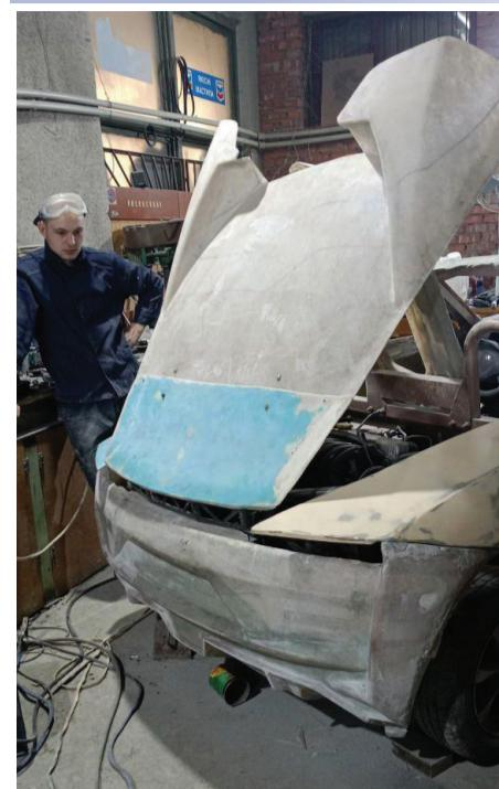
На кафедре «Автомобильный транспорт» Института транспорта и логистики ЛГУ им. В. Даля идет непрерывная работа над луганской версией молодежного спорткара – Родстер Крым. Сегодня на одном из ключевых этапов сборки была установлена крышка моторного отсека. Этот элемент не только выполняет защитную функцию, но и придает автомобилю завершенный вид.
