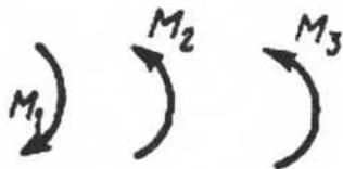
В одной плоскости расположены три пары сил. Определить момент пары сил  $M_3$ , при котором эта система находится в равновесии, если моменты  $M_1 = 510 \text{ Н}\cdot\text{м}$ ,  $M_2 = 120 \text{ Н}\cdot\text{м}$ .
