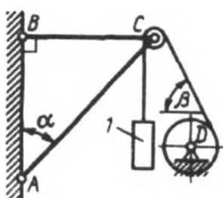
Груз 1 весом 10 Н подведен с помощью каната, перекинутого через блок С и намотанного на барабан лебедки D. Определить усилие в стержне AC, если углы  $\alpha = 45^\circ$ ,  $\beta = 60^\circ$ .
