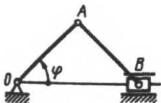
Положение ползуна B определяется углом  $\varphi = \frac{1}{3}\pi t$ . Определить скорость ползуна в момент времени  $t = 1 \text{ с}$ , если  $OA = AB = 1,5 \text{ м}$ .
