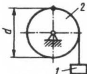
Груз 1 поднимается с помощью лебедки, барабан 2 вращается согласно закону  $\varphi = 5 + 2t^3$ . Определить скорость тела 1 в момент времени  $t = 1$  с, если  $d = 0,6$  м.
