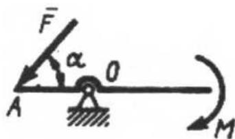
На рычаг с неподвижной осью  $O$  действуют пара сил с моментом  $M = 3 \text{ Н}\cdot\text{м}$  и сила  $\bar{F}$ . Определить модуль силы  $\bar{F}$ , при которой рычаг находится в равновесии, если угол  $\alpha = 45^\circ$ , длина  $AO = 0,3 \text{ м}$ . (14,1)
