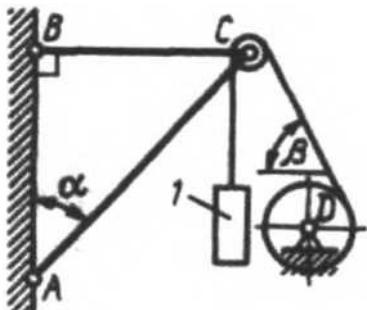
Груз 1 весом 5 кН подвешен с помощью каната, перекинутого через блок С и намотанного на барабан лебедки D. Определить усилие в стержне BC, если  $\alpha = 60^\circ$ ,  $\beta = 30^\circ$ .
