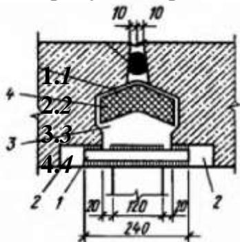
12. Вертикальный колодец стыка стеновых панелей крупнопанельных зданий заполняют:
