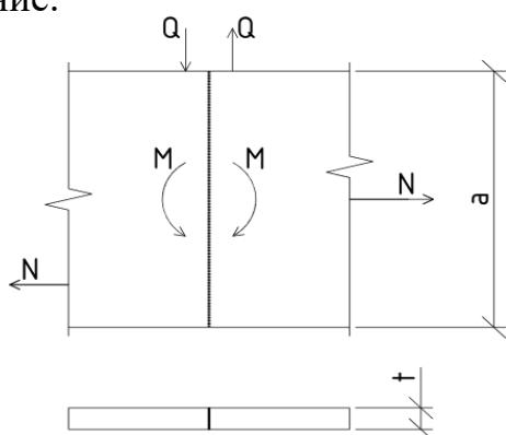
Стыковой сварной шов находится под воздействием усилий  $N$ ,  $M$ ,  $Q$  в сложном напряженном состоянии. Несущая способность такого шва в общем случае определяется приведенными напряжениями:
