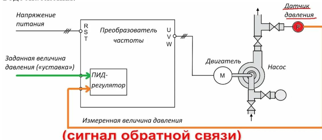
А) Под воздействием сигнала задания преобразователь изменяет скорость вращения электродвигателя насоса и стремится привести отклонение между заданным и реальным значением давления к нулю. В случае падения давления (например, вследствие увеличения расхода воды) ПИД-регулятор увеличит выходную частоту преобразователя частоты, что приведёт к увеличению скорости вращения насоса, и давление в системе начнёт повышаться.
