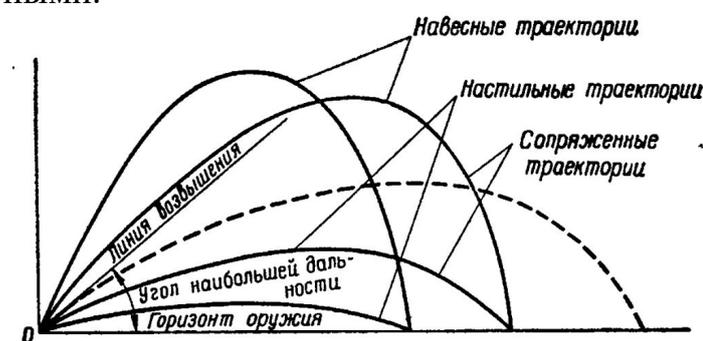
При стрельбе из одного и того же оружия (при одинаковых начальных скоростях) можно получить две траектории с одинаковой горизонтальной дальностью: настильную и навесную. Траектории, имеющие одинаковую горизонтальную дальность при различных углах возвышения, называются сопряженными.
