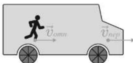
Правильный ответ: Так как пассажир идет в том же направлении, что и автобус, то векторы их скоростей складываются, поэтому абсолютная скорость равна  $v_{abc} = v_{\text{пер}} + v_{\text{отн}} = 10 + 1 = 11 \text{ м/с}$
