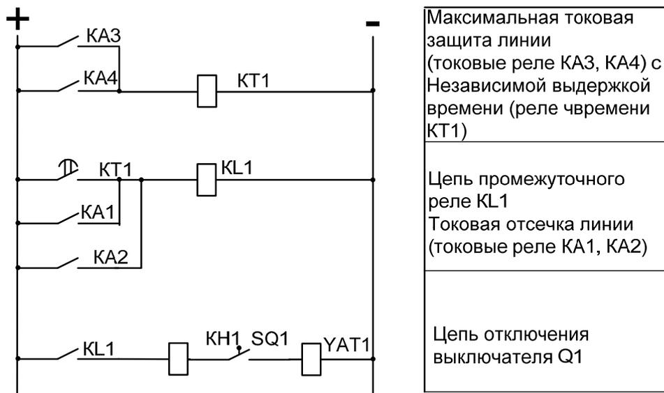
Рис.2. Схемы ТО и МТЗ
