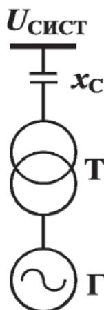
Рис. 2.1. Однолинейная схема блока генератора-трансформатора
