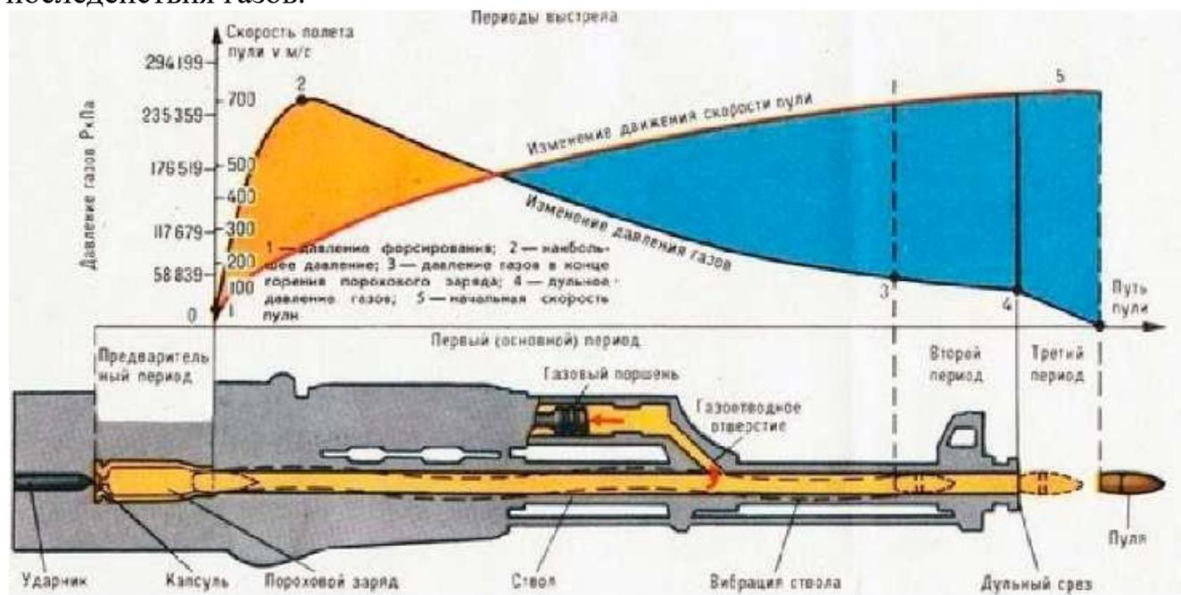
Предварительный период длится от начала горения порохового заряда до полного врезания оболочки пули в нарезы ствола. В течении этого периода в канале ствола создается давление газов, необходимое для того, чтобы сдвинуть пулю с места и преодолеть сопротивление ее оболочки врезанию в нарезы ствола. Горение порохового заряда в этом периоде происходит в постоянном объеме, оболочка врезается в нарезы мгновенно, а движение пули начинается сразу же при достижении в канале ствола давления форсирования.
