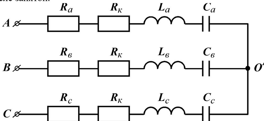
Рис.1 Электрическая схема трехфазной цепи
