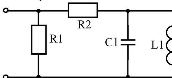
28. Определить в общем виде сопротивление электрической цепи, представленный на рисунке, относительно зажимов CD.
