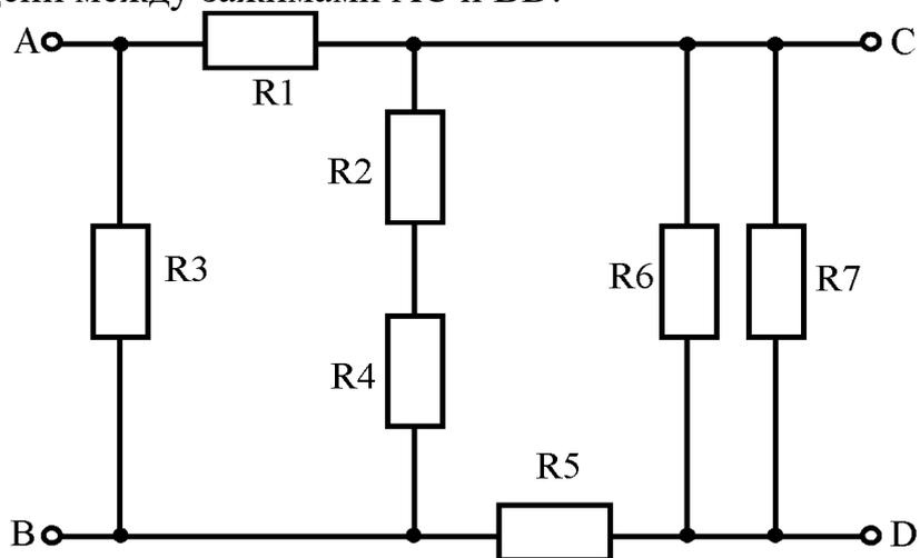
20. Определить в общем виде сопротивление электрической цепи, представленной на рисунке, относительно зажимов AB.
