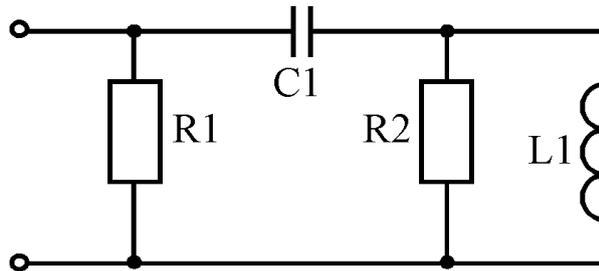
22. Определить в общем виде сопротивление электрической цепи, представленный на рисунке, относительно зажимов AC.
