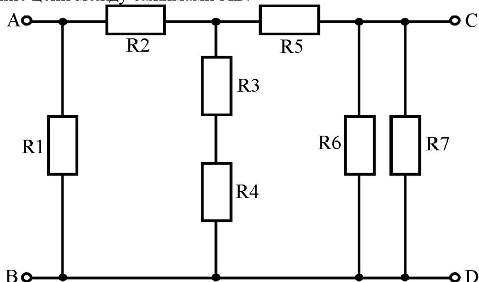
4. На рисунке представлена схема электрической цепи  $R_1 = R_2 = 15\text{ Ом}$ ,  $R_3 = R_6 = 20\text{ Ом}$ ,  $R_4 = R_5 = 17,5\text{ Ом}$ ,  $R_7 = 12\text{ Ом}$ . Определить эквивалентное сопротивление цепи между зажимами CD.
