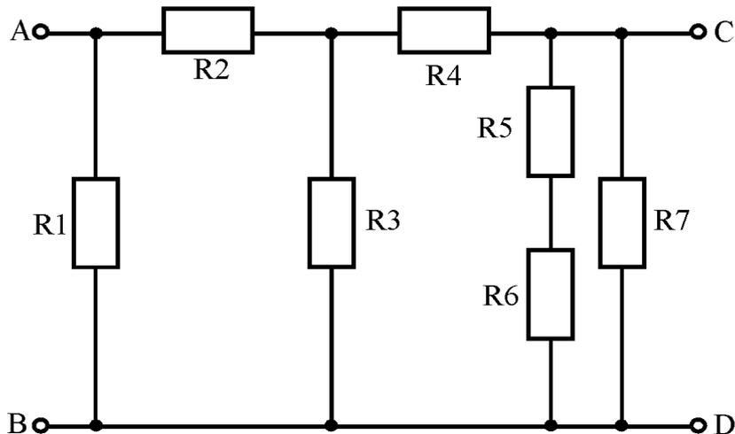
11. На рисунке представлена схема электрической цепи  $R_1 = R_2 = 15 \text{ Ом}$ ,  $R_3 = R_6 = 20 \text{ Ом}$ ,  $R_4 = R_5 = 17,5 \text{ Ом}$ ,  $R_7 = 12 \text{ Ом}$ . Определить эквивалентное сопротивление цепи между зажимами AC и BD.
