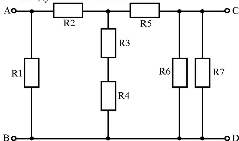
14. На рисунке представлена схема электрической цепи  $R_1 = R_2 = 15 \text{ Ом}$ ,  $R_3 = R_6 = 20 \text{ Ом}$ ,  $R_4 = R_5 = 17,5 \text{ Ом}$ ,  $R_7 = 12 \text{ Ом}$ . Определить эквивалентное сопротивление цепи между зажимами CD.
