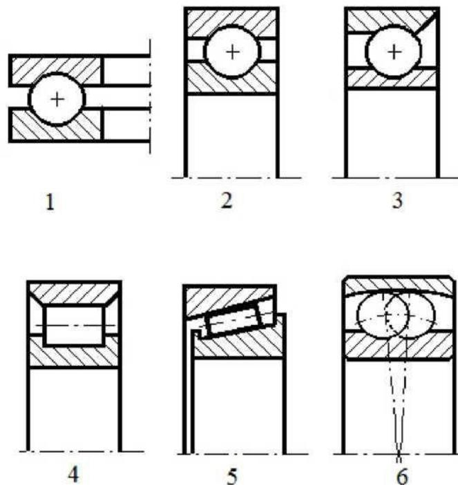
7. В плавающей опоре вала  $\varnothing 60\text{ мм}$  применяется подшипник:
