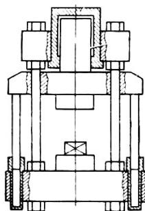
2) Схема винтового пресса
