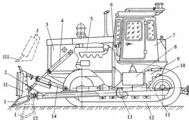
Правильный ответ: отвал, двигатель, сцепление, коробка передач, гусеница
