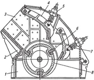
Б) схема молотковой дробилки
