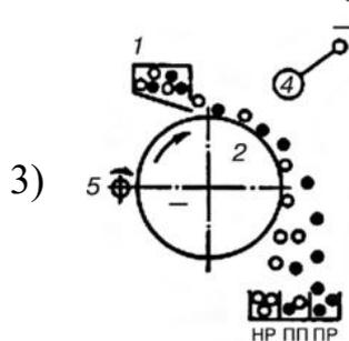
В) схема электродинамического сепаратора
