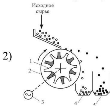
Б) схема электромагнитного сепаратора
