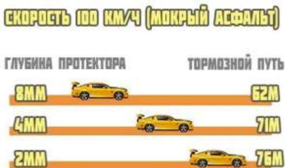
Рисунок 2.2 – Зависимость тормозного пути от глубины протектора
