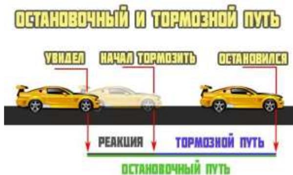
Рисунок 2.1 – Остановочный и тормозной путь
