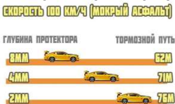
Рисунок 2.2 – Зависимость тормозного пути от глубины протектора
