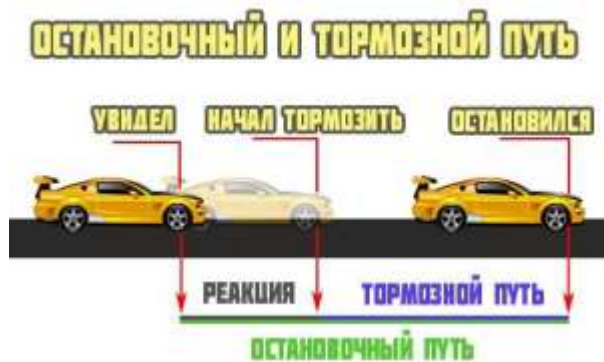
Рисунок 2.1 – Остановочный и тормозной путь
