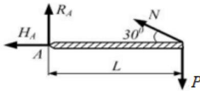
Рассмотрим равновесие элемента. Условие равновесия:  $\sum M_A = N \sin 30^\circ L - PL = 0$ . Откуда  $N = 2P$ . Напряжение  $\sigma = \frac{N}{F} = \frac{8P}{\pi d^2}$ . Из закона Гука  $\varepsilon = \frac{\sigma}{E} = \frac{8P}{\pi d^2 E}$ .
