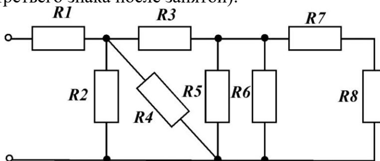
$$R_1 = 15 \text{ Ом}; \quad R_3 = 4 \text{ Ом}; \quad R_5 = 9 \text{ Ом}; \quad R_7 = 4 \text{ Ом};$$
