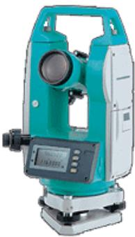
Г) электронный тахеометр
