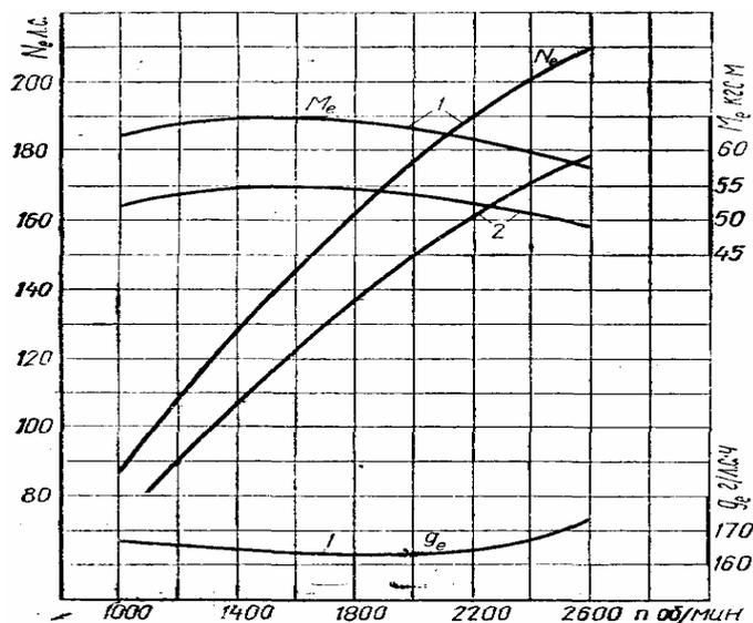
Рисунок – 1 Скоростные характеристики двигателей ЯМЗ-740(1), ЯМЗ-740(2)
