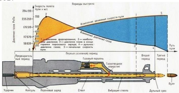
Предварительный период длится от начала горения порохового заряда до полного врезания оболочки пули в нарезы ствола. В течении этого периода в канале ствола создается давление газов, необходимое для того, чтобы сдвинуть пулю с места и преодолеть сопротивление ее оболочки врезанию в нарезы ствола. Горение порохового заряда в этом периоде происходит в постоянном объеме, оболочка врезается в нарезы мгновенно, а движение пули начинается сразу же при достижении в канале ствола давления форсирования.
