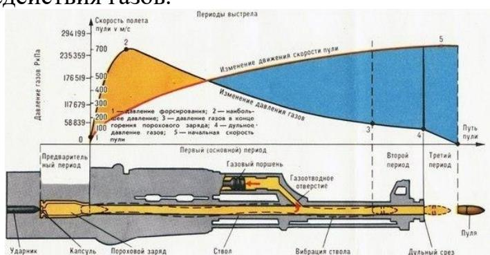
Предварительный период длится от начала горения порохового заряда до полного врезания оболочки пули в нарезы ствола. В течении этого периода в
