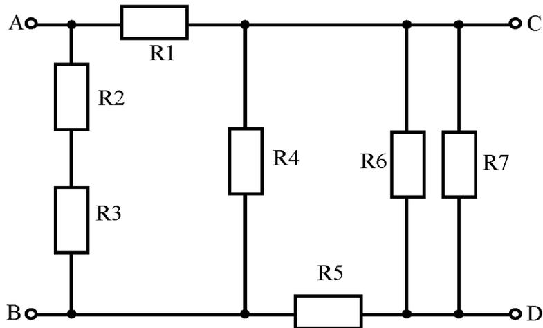
17. На рисунке представлена схема электрической цепи  $R_1 = R_2 = 15 \text{ Ом}$  ,  $R_3 = R_6 = 20 \text{ Ом}$  ,  $R_4 = R_5 = 17,5 \text{ Ом}$  ,  $R_7 = 12 \text{ Ом}$  . Определить эквивалентное сопротивление цепи между зажимами CD.
