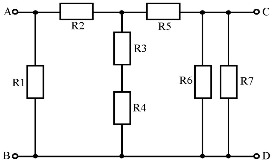
4. На рисунке представлена схема электрической цепи  $R_1 = R_2 = 15 \text{ Ом}$ ,  $R_3 = R_6 = 20 \text{ Ом}$ ,  $R_4 = R_5 = 17,5 \text{ Ом}$ ,  $R_7 = 12 \text{ Ом}$ . Определить эквивалентное сопротивление цепи между зажимами CD.
