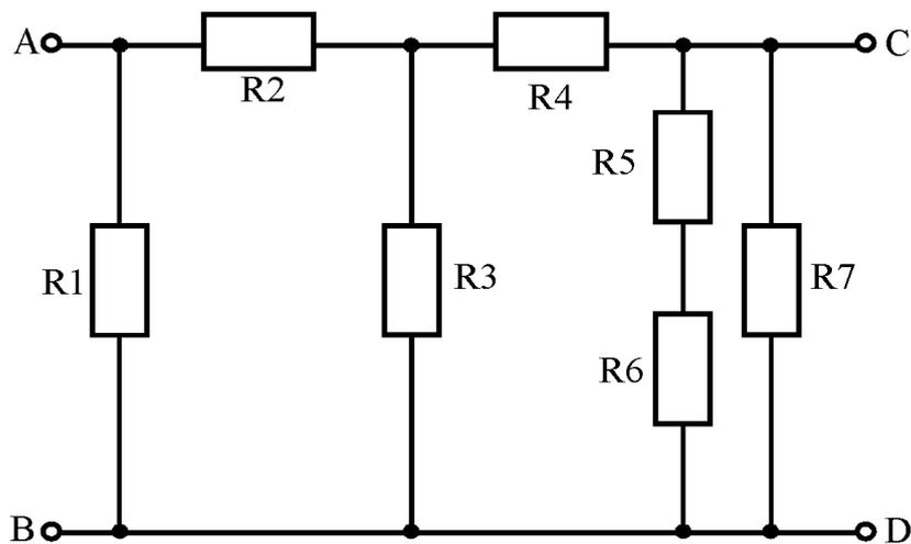
11. На рисунке представлена схема электрической цепи  $R_1 = R_2 = 15 \text{ Ом}$ ,  $R_3 = R_6 = 20 \text{ Ом}$ ,  $R_4 = R_5 = 17,5 \text{ Ом}$ ,  $R_7 = 12 \text{ Ом}$ . Определить эквивалентное сопротивление цепи между зажимами AC и BD.
