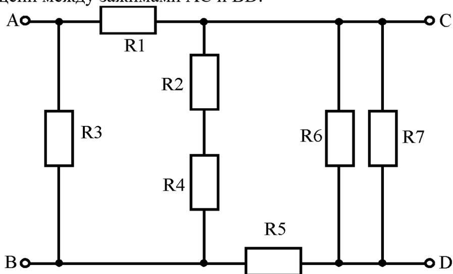
9. Определить эквивалентное сопротивление схемы, представленной на рисунке, если  $R_1 = 100\text{ Ом}$ ,  $R_2 = 75\text{ Ом}$ ,  $L_1 = 750\text{ мГн}$ ,  $C_1 = 30\text{ мкФ}$ . Рассчитать главный ток электрической цепи.
