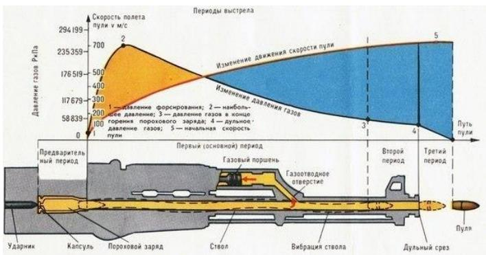
Предварительный период длится от начала горения порохового заряда до полного врезания оболочки пули в нарезы ствола. В течении этого периода в канале ствола создается давление газов, необходимое для того, чтобы сдвинуть пулью с места и преодолеть сопротивление ее оболочки врезанию в нарезы ствола. Горение порохового заряда в этом периоде происходит в постоянном объеме, оболочка врезается в нарезы мгновенно, а движение пули начинается сразу же при достижении в канале ствола давления форсирования.
