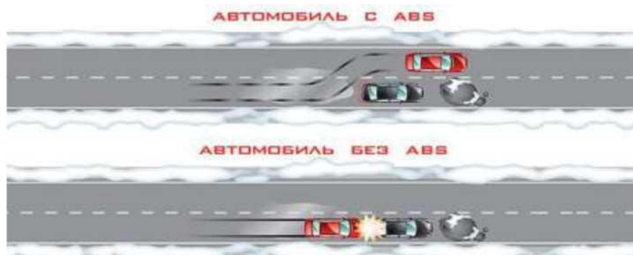
Рисунок 2.3 - Сохранение управляемости автомобилем, оснащённым ABS при экстренном торможении.
