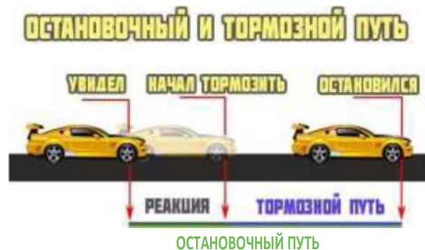
Рисунок 2.1 - Остановочный и тормозной путь
